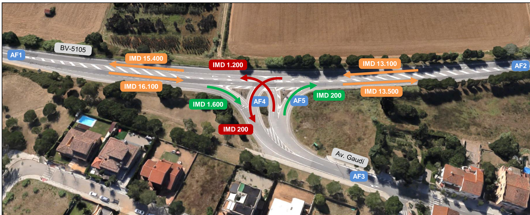
IMD i situació dels aforadors a la intersecció entre la BV-5105 i l'accés sud a Santa Agnès de Malanyanes
